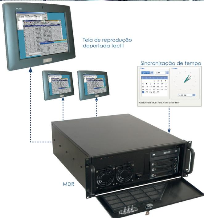
O gravador digital multicanal MDR é um dispositivo de arquivamento para a gravação da voz.
